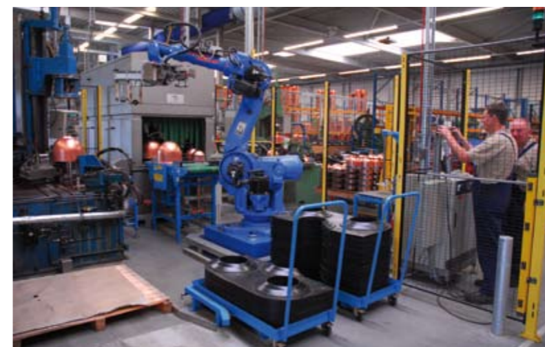
Roboter-Einsatz: Dieser setzt gerade eine Kesselhälfte auf eine Abstechmaschine
